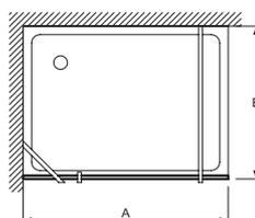
Спецификация продукта: Фиксированное душевое ограждение с матовым стеклом 90 см. E22WD90. Коллекция: CONTRA. РАЗМЕРЫ (СМ): 200 x 90 см. ВЕС: 39 кг. ТИП УСТАНОВКИ: Угловые. МИН/МАКС ШИРИНА: 87 - 89 см. МИН/МАКС ШИРИНА: 87 - 89 см. ТОЛЩИНА СТЕКЛА В ММ: 8. ВЫСОТА ПАНЕЛИ В СМ: 200. АКСЕССУАРЫ: Профиль. ТИП ДУШЕВОГО ОГРАЖДЕНИЯ: Распашные. УСТАНОВКА: Открытое пространство. ОПЦИЯ: Фиксированная панель 30 см.
